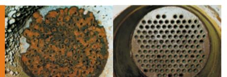
Esempio pratico: condizioni di 2 scambiatori di calore operanti in parallelo per due anni senza interventi di pulizia
