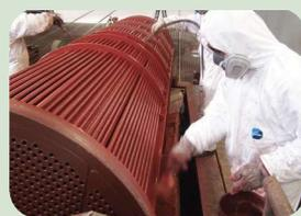
échangeurs à faisceau tubulaire
