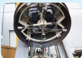
décapage par abrasif en automatique et revêtement intérieur
