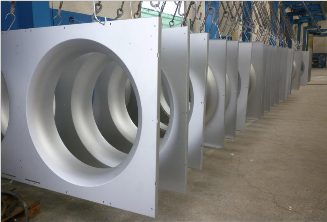
*Pannelli di supporto ventilatori al termine della verniciatura Thermoguard.*
