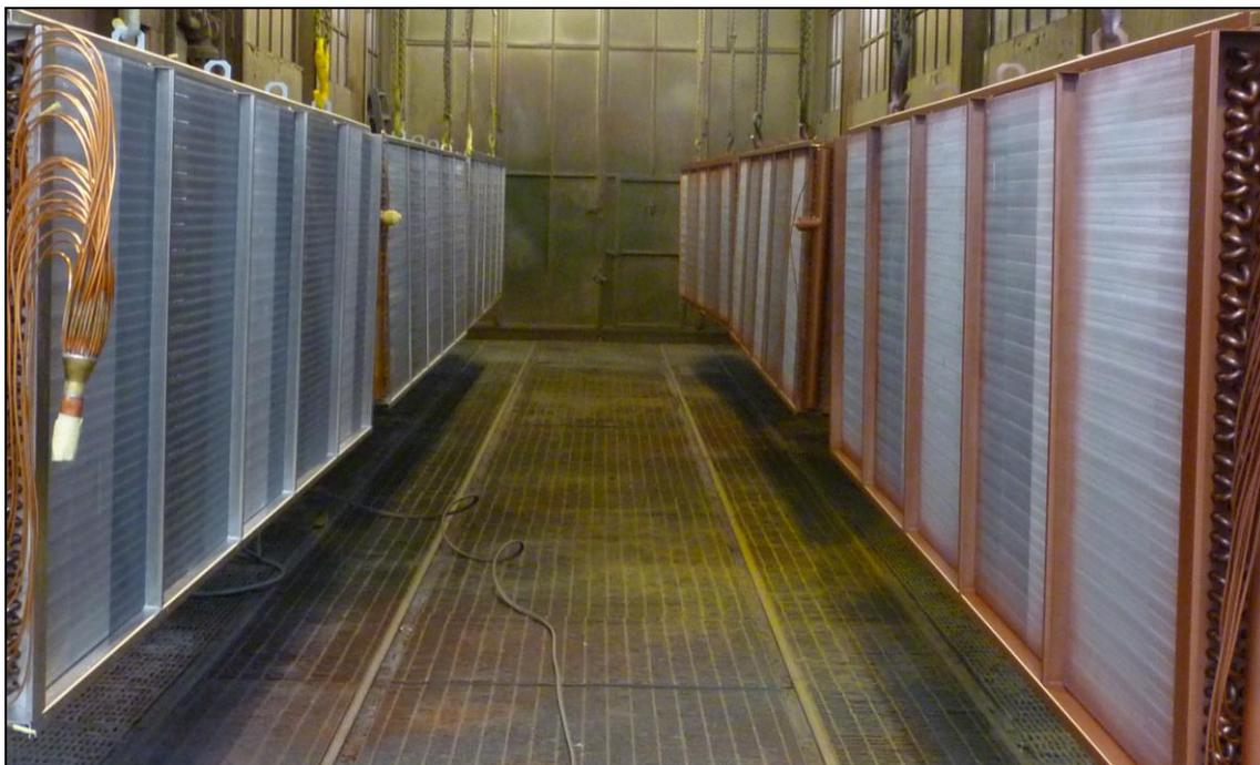
*Batterie in cabina di verniciatura dopo applicazione del primer.*
