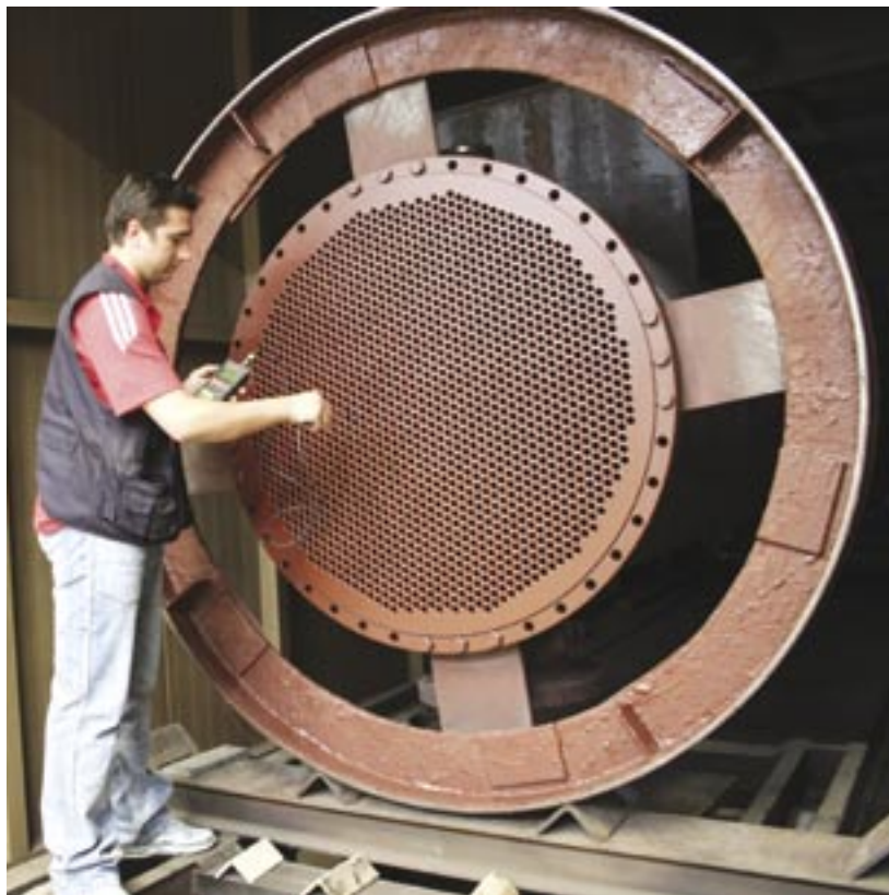
Fig. 14 - Il direttore di produzione Alessio Trisolino mentre effettua alcuni controlli qualitativi sul rivestimento interno dello scambiatore
